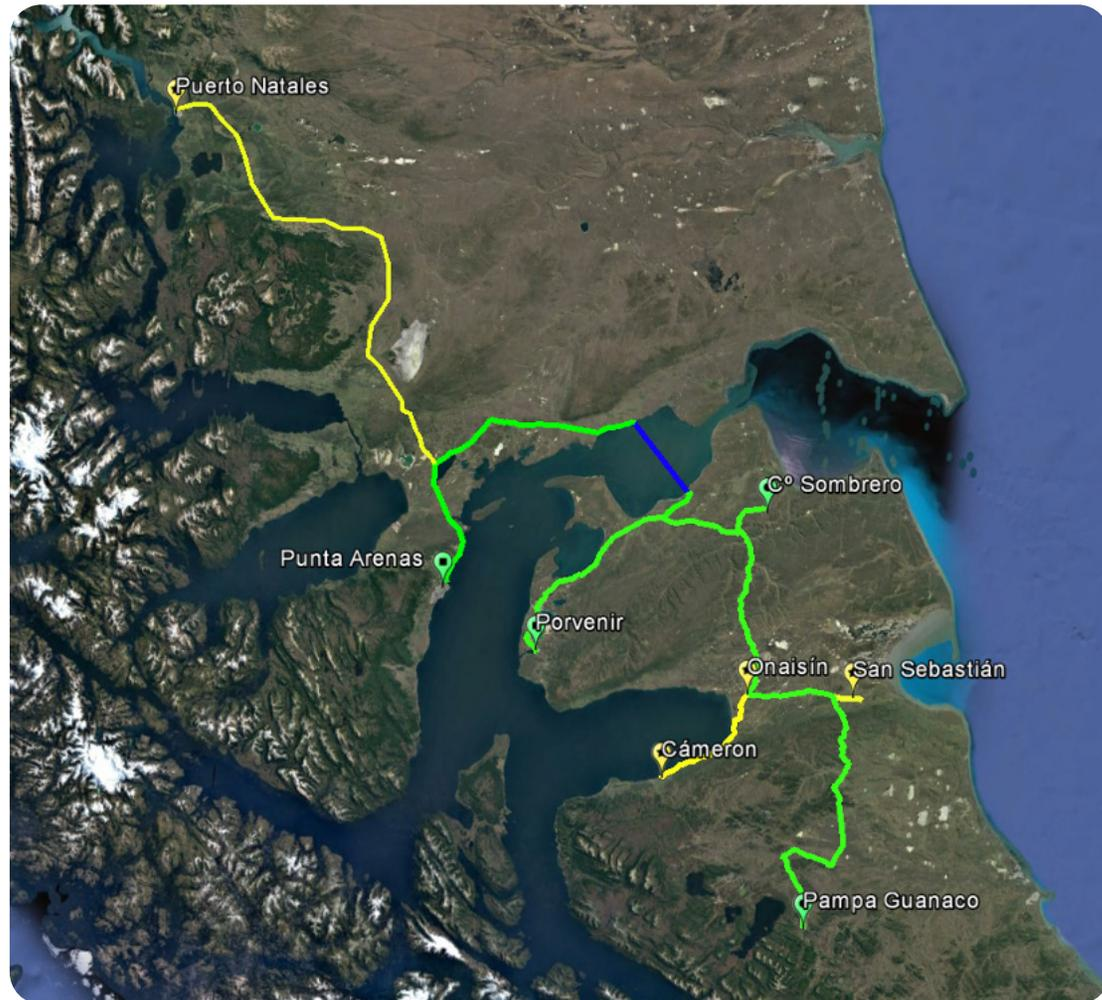
Asimismo, para la conexión de dichos POIIT Terrestres, la Beneficiaria efectuó el despliegue de los TRIOT Terrestres sobre la faja fiscal de las rutas de la región, siendo más de 730 [km] de cable de fibra óptica instalados de manera directamente soterrada, 38 [km] de forma aérea y 34 [km] de cable submarino de fibra óptica para cruzar en el Estrecho
