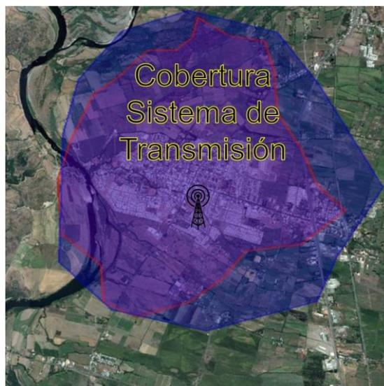
**Ilustración 2:** La Zona de Servicio corresponde a la cobertura comprometida (área azul) que permite una tolerancia de 30%.
