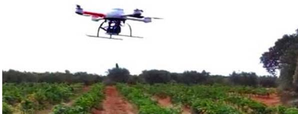
**Ilustración 19: Dron usado para teledetección**
