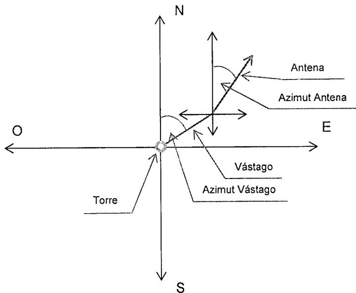
Esquema de configuración vástago, antena.
