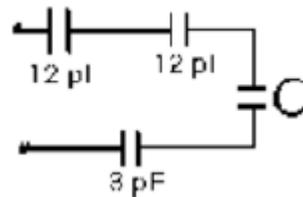
**26.- Para que la capacidad equivalente total del circuito de la figura sea de 100 pF el condensador C debe ser:**
