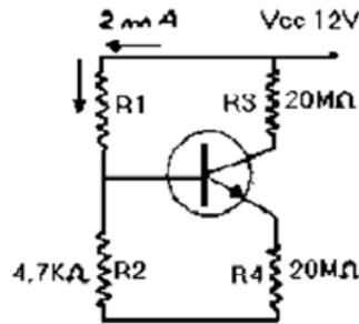
34.- El transistor de la figura no conduce, sin embargo circula una corriente de 100 microamperes por R1 y R2. ¿Cuál es el valor total de ambas R?:
