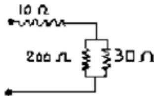
**2.-** El circuito serie-paralelo tiene una resistencia total de:
