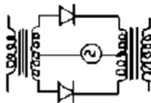
**60.-El número mínimo de diodos necesarios para rectificación de ondas completas es:**
