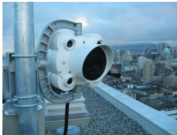
Figura A.2.5 Transceptor para FSO (Fuente: http://www.free-space-optics.org )
