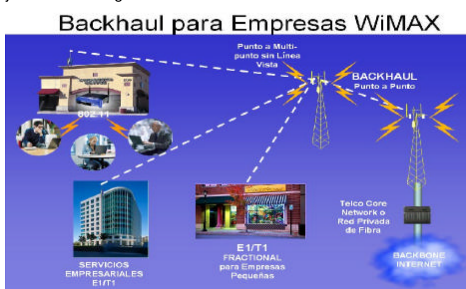
Figura A.1.13 Diagrama de Bloques Backhaul para Empresas Wimax (Fuente: IEEE)
