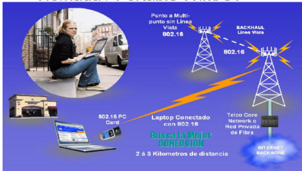
Figura A.1.15 Diagrama de Bloques Sistemas Nómada y Portátil WiMAX (Fuente: IEEE)
