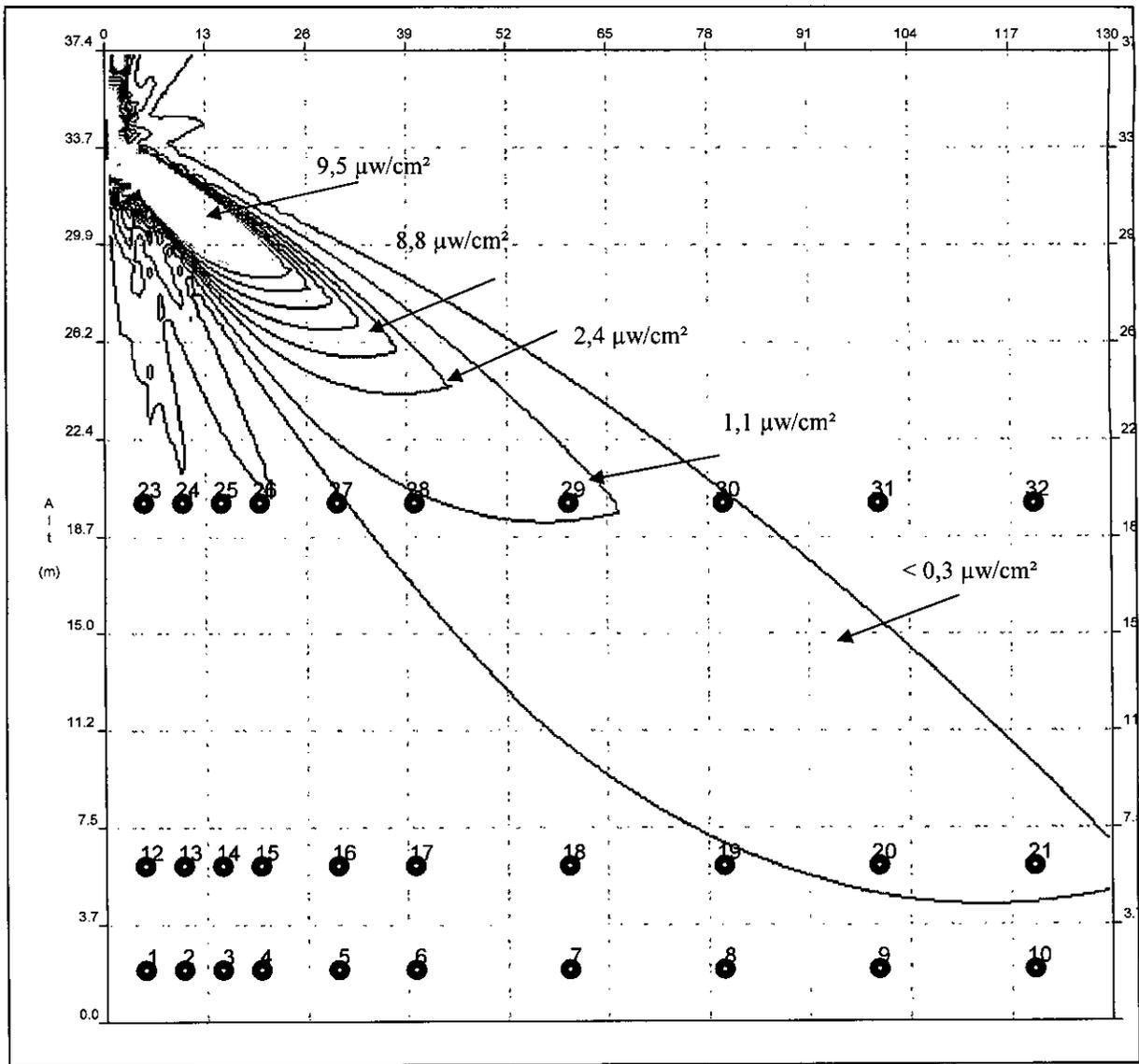
La simulación entrega los mayores valores a 33 metros de altura y a centímetros del elemento radiante, decreciendo en función de la distancia y la altura del punto observado. La norma utilizada por los países de la OCDE establece una medición a 1,5 metros, lo cual representaría el nivel de radiación en lugares de tránsito de las personas, tal como se indica en el artículo 6° de la presente resolución.
